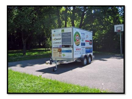
Der Anhänger ist beim Abstellen und vor dem Ausladen des Street-Soccer-Felds durch die Feststellbremse, sowie vorne und hinten durch Absenken der Stützen zu sichern. Zusätzlich ist der Anhänger vorne und hinten mit einem Schloss zu sichern.
